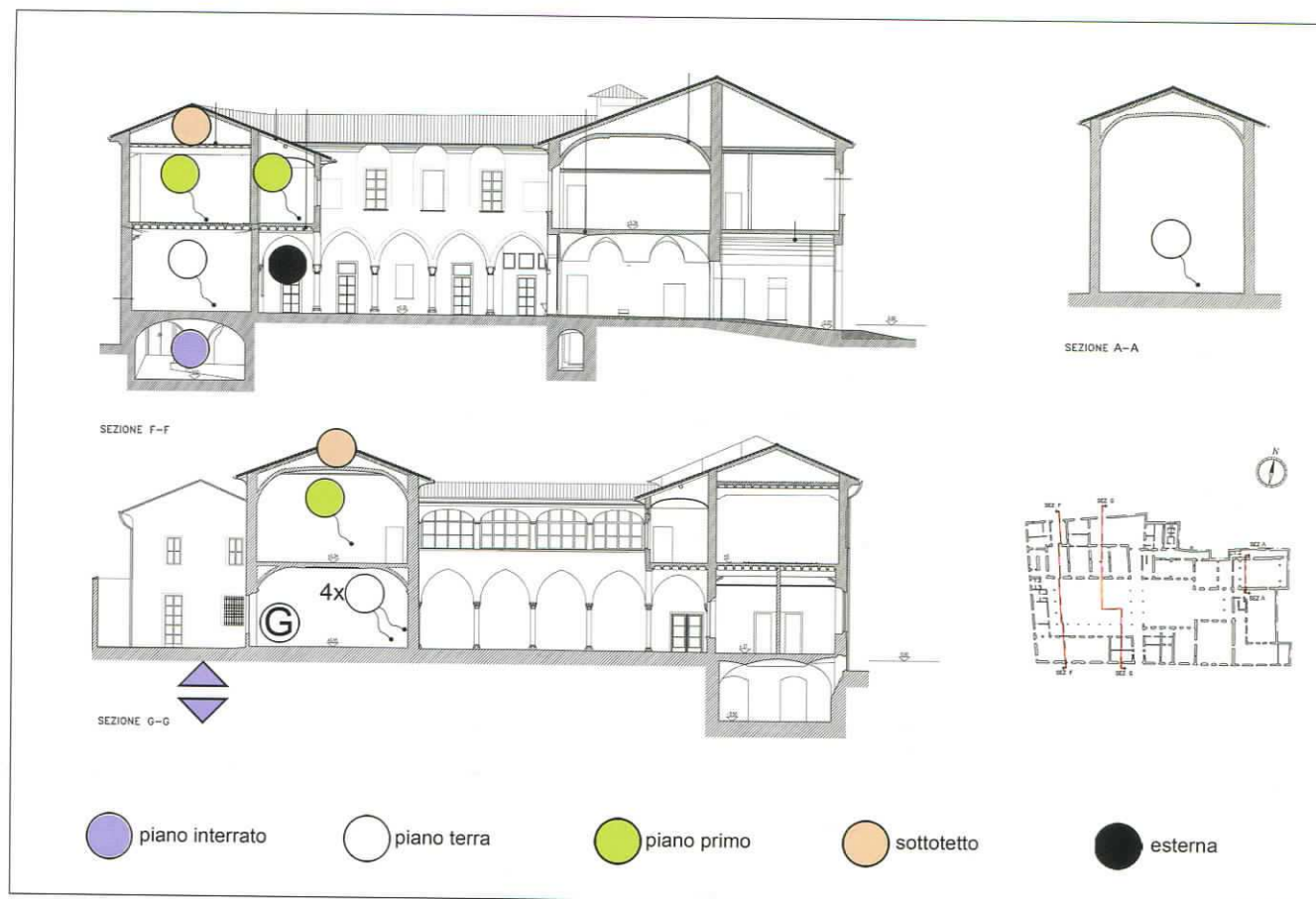
13. Cremona, Palazzo Pallavicino. Section of the proposed monitoring scheme (Picture: Laboratorio di Analisi e Diagnostica del Costruito, Politecnico di Milano)
